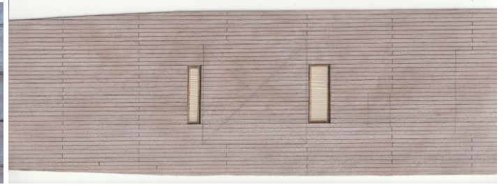
Het gereede dek t.p.v. de ketel met los ingelegde roosters
