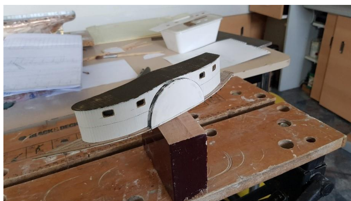
De pasgemaakte en gemonteerde wand, met Raamkozijnen met de plexiglas ramen.
